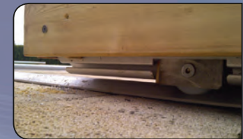
• Bremse mit Gummibacke und Führungsrad
